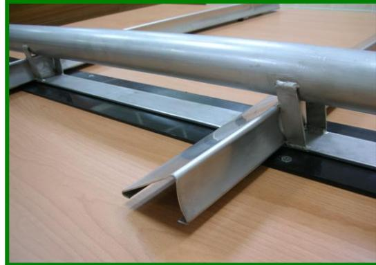
楔形刮板的凹面刮削污泥層下部的污泥，在其返回過程中，返回速度大約是前進速度的兩倍，楔形刮板在污泥層底部滑動而不擾亂污泥沉澱進程。
